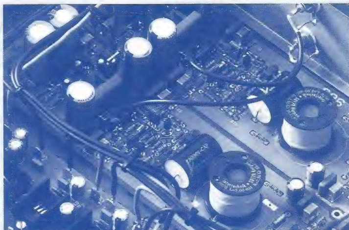
De analoge uitgangspunten van de MP-DAC. Passieve LC-filtering en klasse-A uitgang zonder tegenkoppeling.
